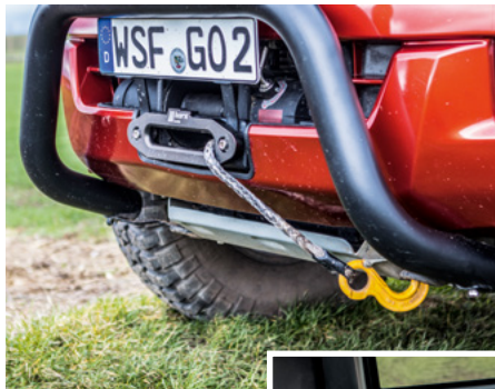
Zugstark: Die Seilwinde von Horntools hilft in der Not. Sie ist auf das Gewicht des D-Max ausgelegt.
